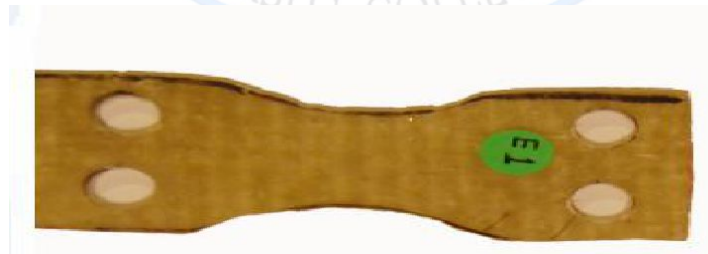
( B ) الصور الفوتوغرافية لمتراكب الايبوكسي المدعمة بثلاث طبقات من ألياف الزجاج بعد اختبار الكلال
